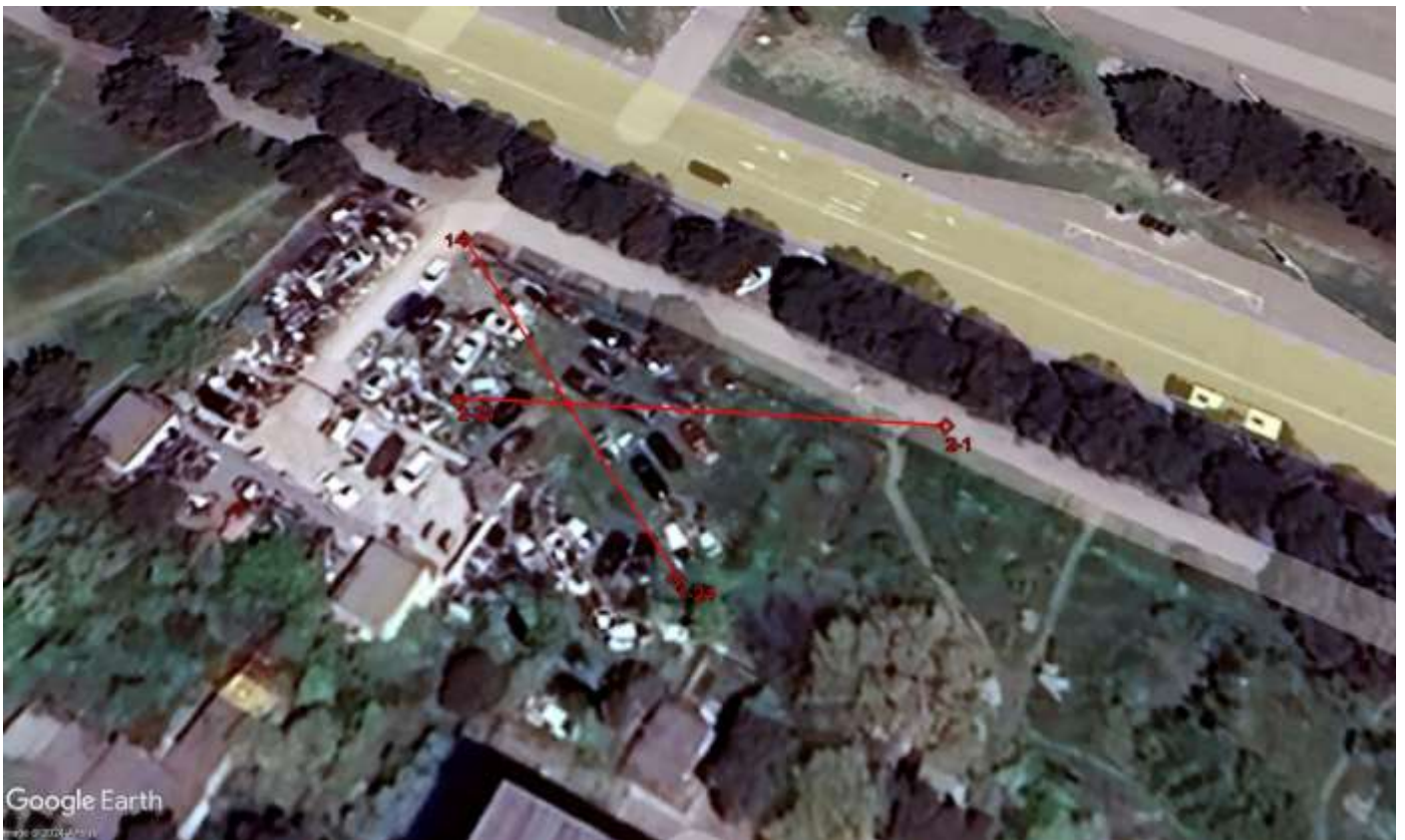
ნახ.1. საკვლევი უბანი და სეისმური პროფილების განლაგების სქემა. #1 მიუთითებს პირველ გეოფონს ანუ პროფილის დასაწყისს, ხოლო #24 - 24-ე გეოფონს ანუ პროფილის ბოლოს.
